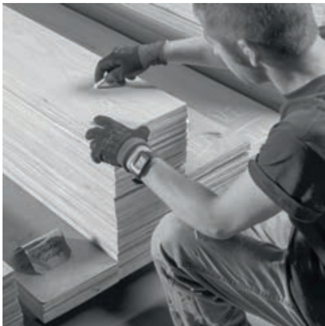
Selezione delle lamelle Selection of the slat
